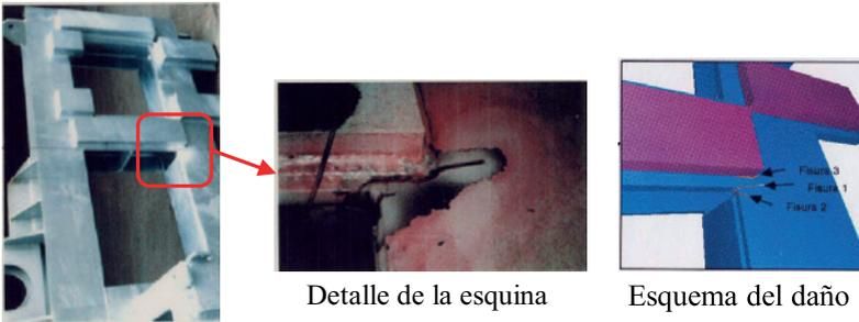
Figura 25. Daño en chasis de aerogenerador, estudiado y resuelto en el GERM
