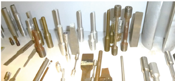
Figura 1.26. Geometrías de probetas para el ensayo de tracción
