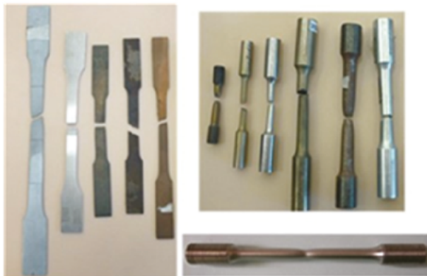
Figura 1.28. Estricción de la probeta y tipos de roturas
