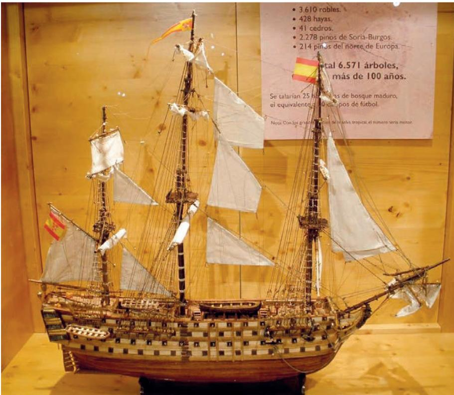
Figura 2. Modelo del Santísima Trinidad (MNM) Navío construido «a la inglesa» por Ignacio Mullan y botado en La Habana en 1769, representa la primera versión del famoso navío de tres puentes y 112 cañones
