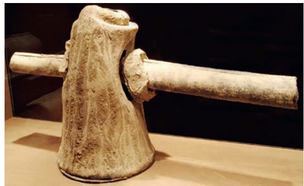
Figura 8. Purgador de tuberías de procedencia desconocida conservado en el Museu de l'Aigua. Molí de Rigat, Vilanova del Camí (Foto: J. Miñana)
