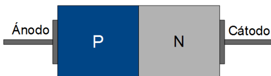
Figura 2.2 Esquema de la estructura interna del diodo, en la que se muestra la unión PN.
