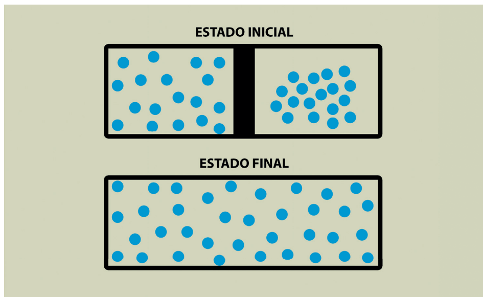
Figura 3. Estado inicial de un sistema compuesto por un gas distribuido en dos cámaras separadas y a diferentes temperaturas (arriba). Estado final del sistema tras eliminarse el compartimento y haberse alcanzado el equilibrio térmico (abajo).
